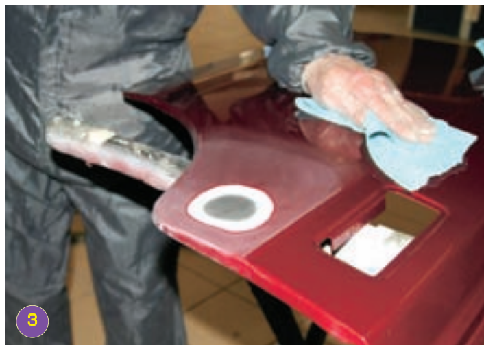
3 Перед грунтованием ремонтируемый участок обезжиривается.
