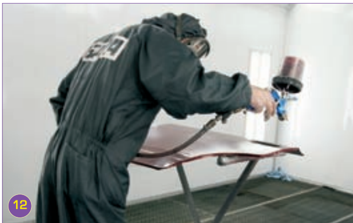
12 На грунт наносят первый слой базы.
