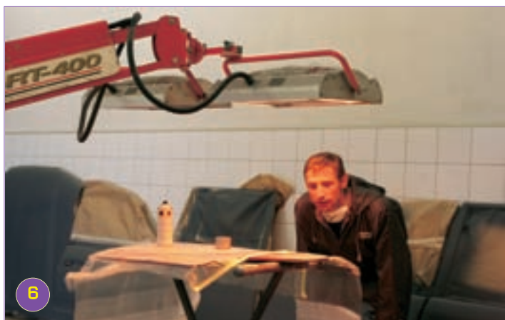
6 С помощью ИК-сушки грунт высыхает очень быстро.
