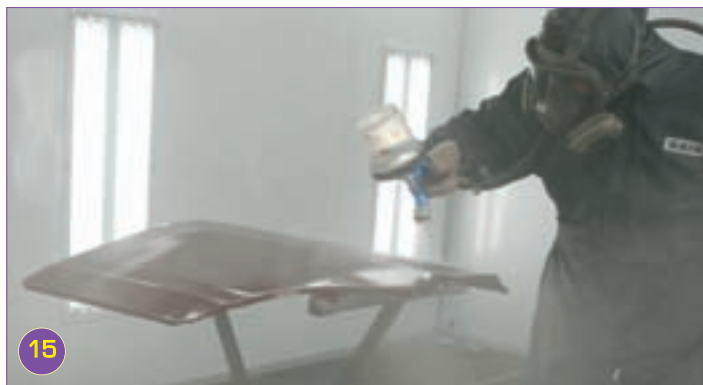
15 После небольшой выдержки — окончательная операция: всю панель покрывают лаком.
