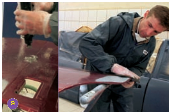
9 Всю окрашиваемую поверхность обрабатывают матирующей пастой 3М.
