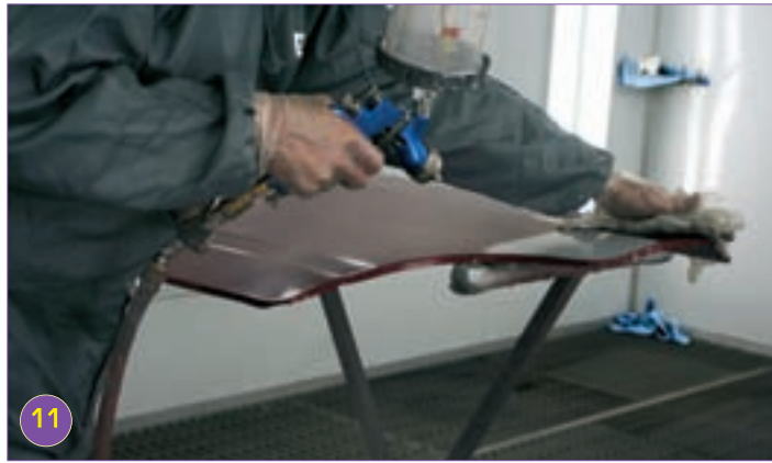
11 На участок ремонта будет нанесена «перламутровая» база, поэтому вначале обрабатывают поверхность специальным составом, предотвращающим неправильную ориентацию частиц пигмента.
