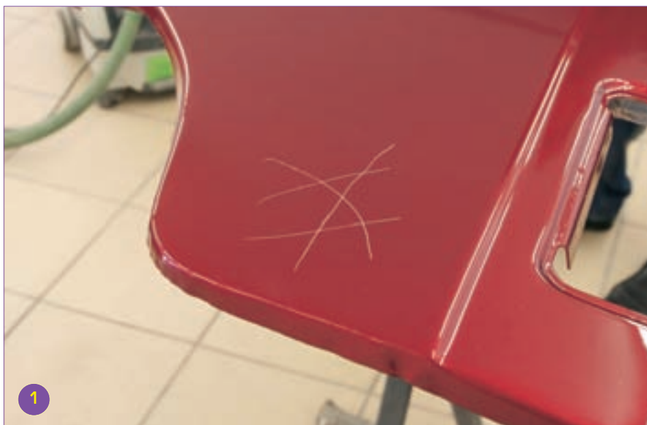
Повреждение на панели незначительное, но внешний вид автомобиля безнадежно испорчен.
