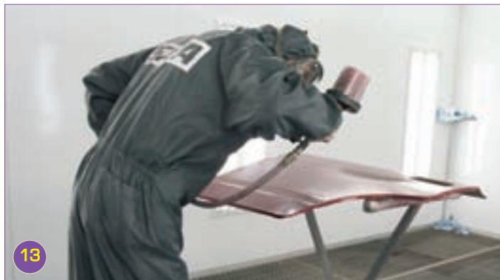
13 После короткой выдержки способом «мокрый по мокрому» наносят второй слой базы, создавая плавный переход к неповрежденному покрытию.
