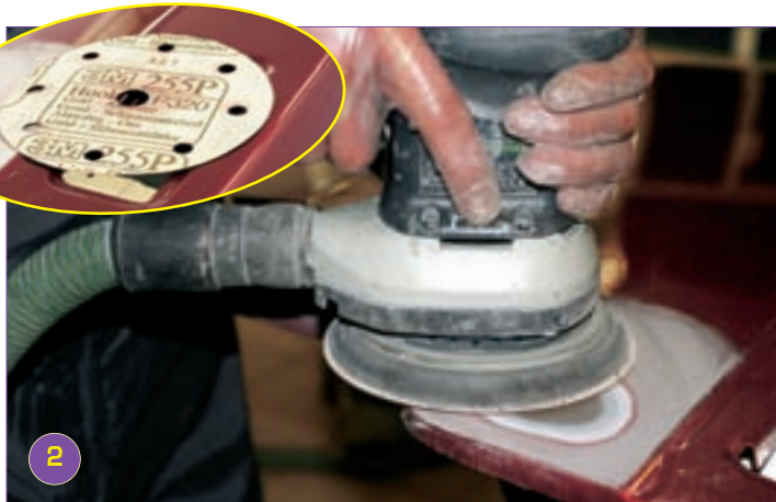
2 Поврежденный участок расшлифовывается шлифмашинкой с абразивным материалом зернистостью P220–P320. При шлифовании необходимо полностью удалить царапины, создав плавный переход к неповрежденному покрытию.
