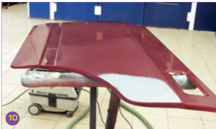
10 После мойки, обезжиривания и сушки панель переместится в кабину ОСК.
