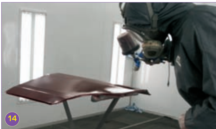
14 Так как использовали аэрозольный грунт без подгонки его цвета, для полной укрывистости приходится нанести третий слой базы. Слой наносят с плавным переходом к неповрежденному покрытию.
