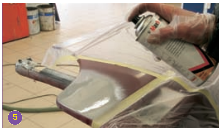
5 На зону ремонта наносится аэрозольный грунт от внешних границ к центру.
